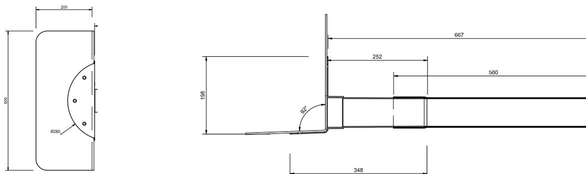
Wasserspeier als Notüberlauf DN 75 mit vorgefertigter Kunststoffmanschette
