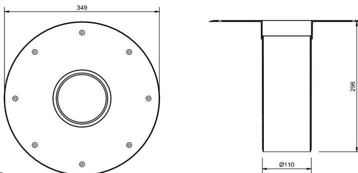
Wasserspeier DN 75 mit vorgefertigter Bitumenmanschette
