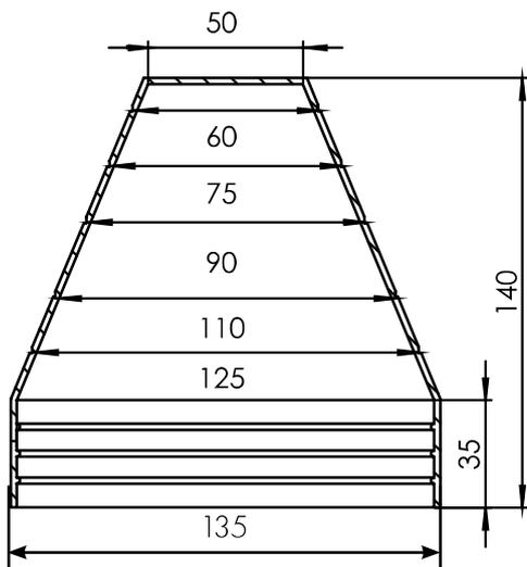
EPDM-Stufenmanschette für Flavent Pro Rohrbogen-Set DN 125 / 160
