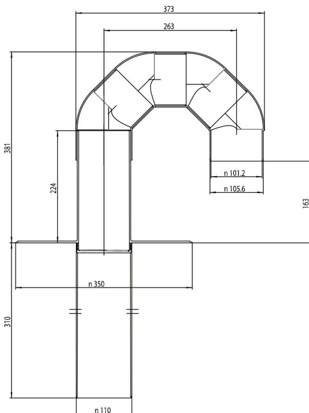
EPDM Stufenmanschette für Flavent Dachdurchführungen DN 75 und DN 110
